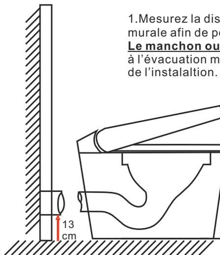
1. Mesurez la distance entre la sortie du WC et l'évacuation murale afin de pouvoir adapter la longueur du raccordement. **Le manchon ou pipe souple n'est pas fourni** car dépend spécifiquement de l'installation.
